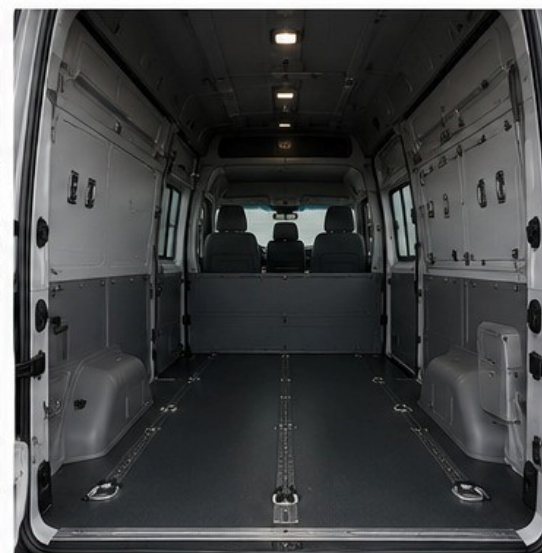
INTERIOR VAZIO – ESTRUTURAS PARA AMARRAS E FIXAÇÃO
