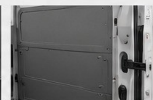
PAREDE COM PROTEÇÃO EM POLIPROPILENO
